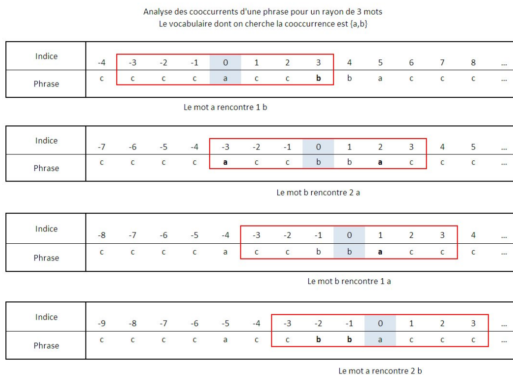
Figure 4.18 — Exemple d'analyse d'une phrase pour la liste de vocabulaire {a,b} avec une fenêtre de 3 mots
